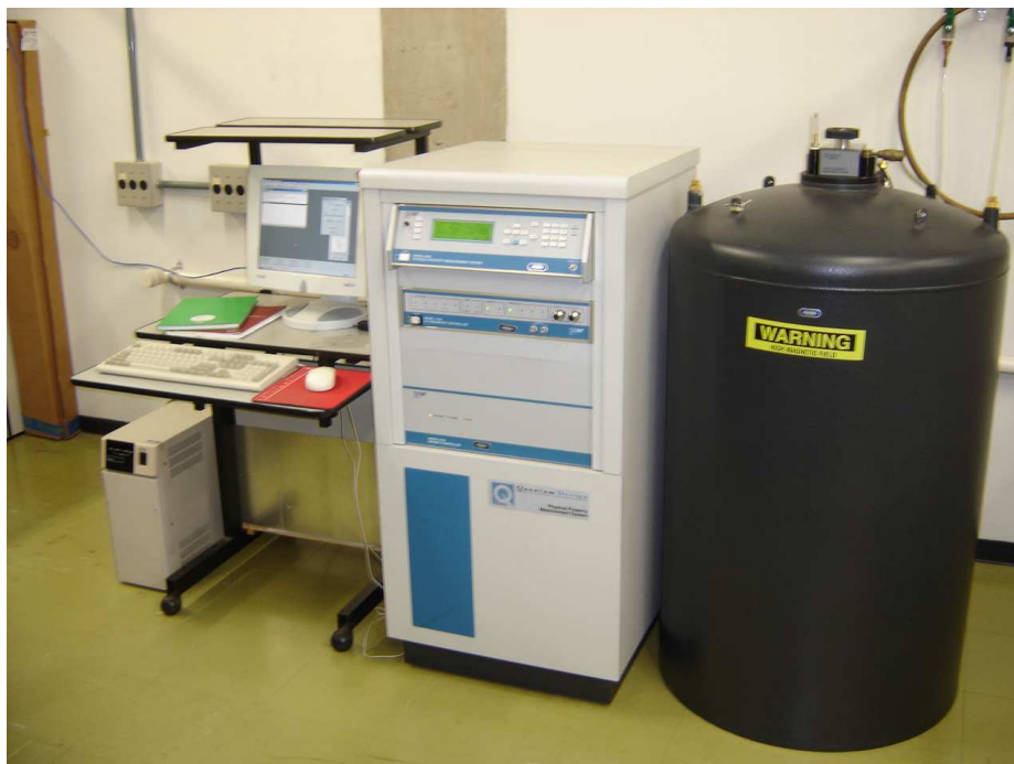
Figura 14: Estação experimental PPMS ( Physical Properties Measurements System ), modelo 6000, fabricada pela Quantum Design .
