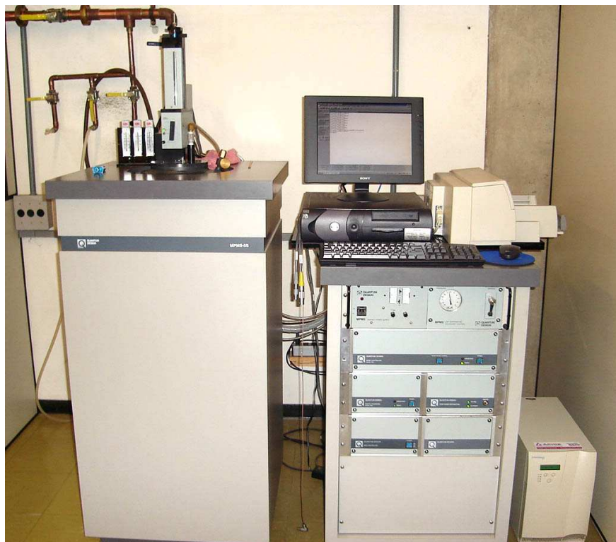
Figura 17: Magnetômetro modelo MPMS-5S – Quantum Design com sensor SQUID utilizado para as medias de suscetibilidade magnética DC nas ligas de Cr-Ti.
