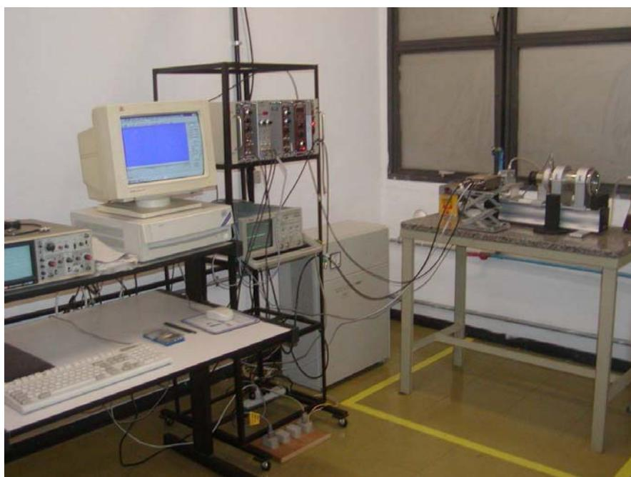
*Figura 32: Foto do Espectrômetro Mössbauer utilizado*
