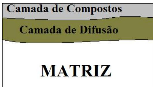
*Figura 08: Esquema das Camadas formadas na nitretação.*
