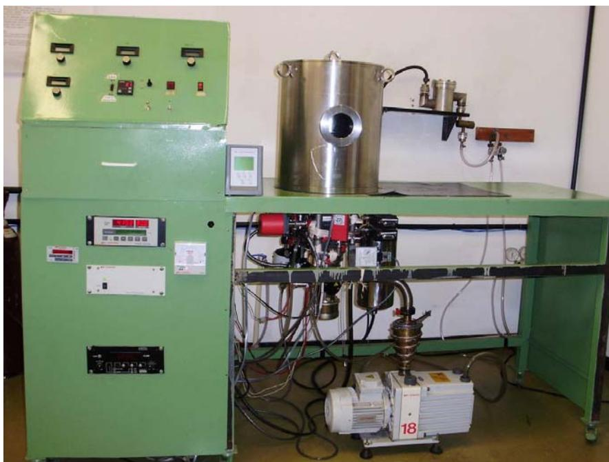
*Figura 31: Foto do Nitretador utilizado*
