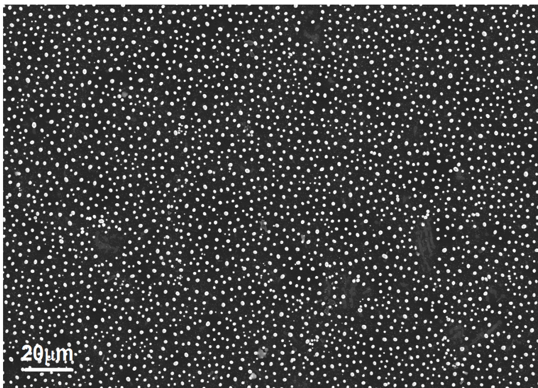
Figura 11: Imagem obtida por microscopia de varredura do substrato após o tratamento térmicos para a formação de nanopartículas de Au.
