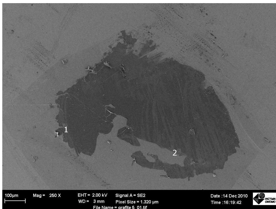
Figura 5.22: Microscopia FEG-SEM da superfície da amostra 5, que mostra os pontos onde foram realizadas as medidas Raman.
