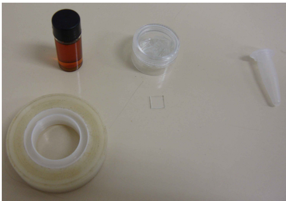
Figura 5.2: Materiais utilizados na preparação das amostras. Verniz, vidro porta-amostra, fita adesiva e eppendorf para armazenar as amostras.
