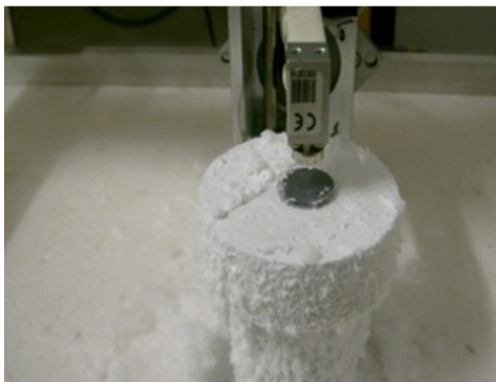
FIGURA 94. Porta amostra (dedo frio) com amostra em forma de pastilha na temperatura próxima de 77 K (Nitrogênio líquido).
