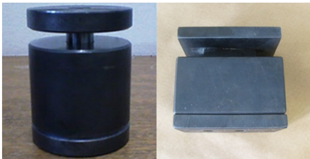
Figura 6. Forma de encaixe dos moldes tanto para cilindros e para a barra.
