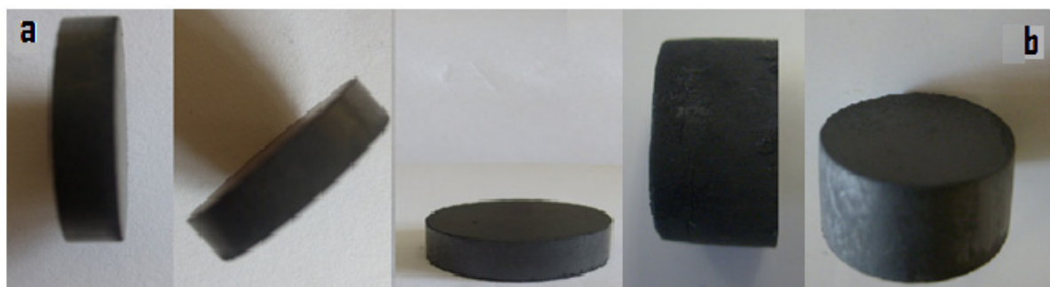
FIGURA 69. Amostras com formato cilíndrico fabricado pelo método da moagem direta
