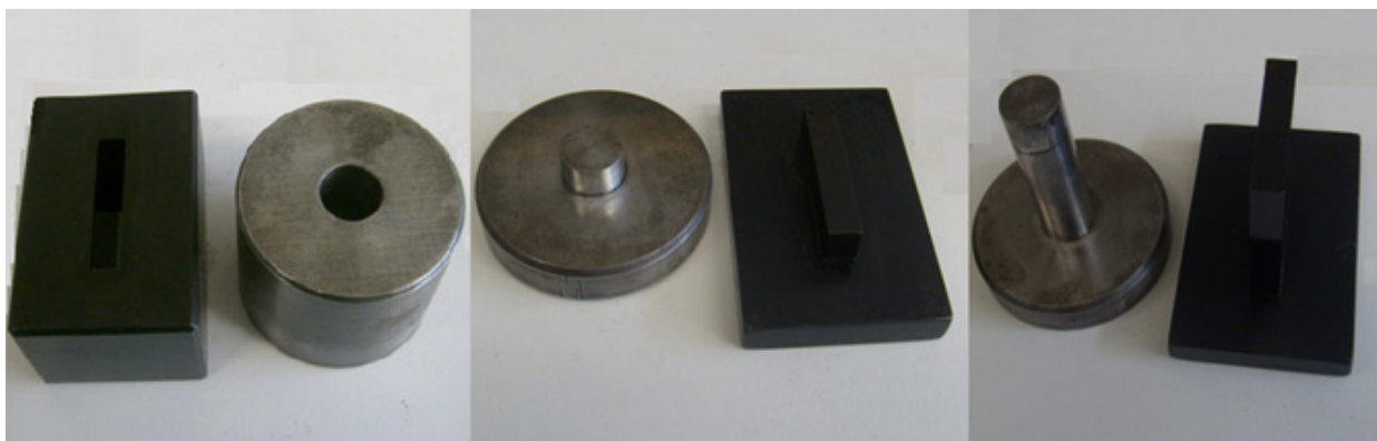
Figura 3. Cilindro e barra de aço mostrando os três componentes dos moldes, antes da usinagem.
