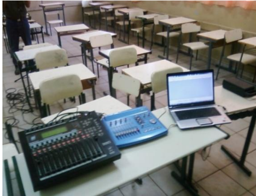
Figura 34 - Equipamentos utilizados para medição do tempo de reverberação de algumas salas de aula.
