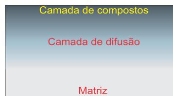
Figura 4: Camadas formadas durante a nitretação a plasma
