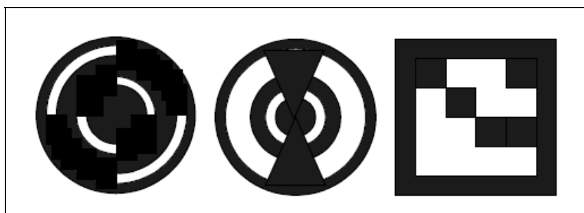
Figura 15 – Três gerações de marcadores fiduciais (NAIMARK; FOXLIN, 2002)
