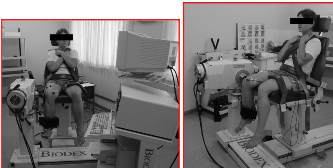
Figura 5- Posicionamento da voluntária no dinamômetro isocinético para a realização da contração isométrica voluntária máxima (CIVM).
