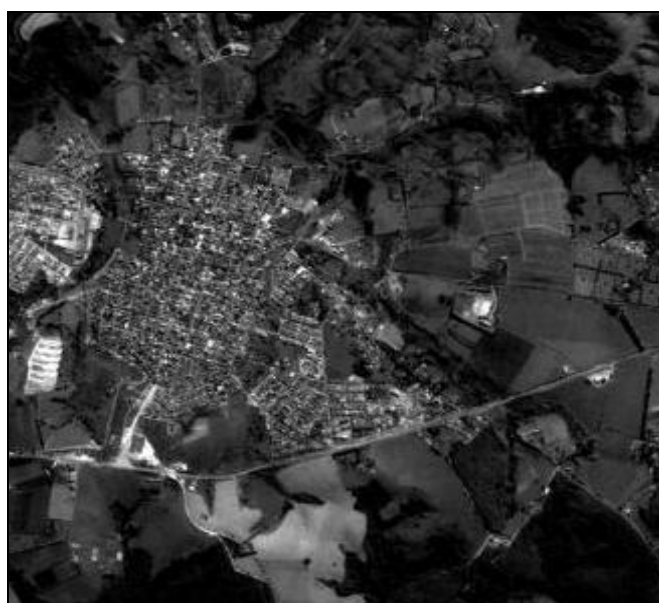
Figura 4. Imagem do sensor HRC do satélite CBERS 2B, com resolução de 5 metros.
