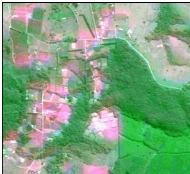
Figura 7. Produto híbrido das bandas 3, 4, 5 do sensor CCD multiespectrais com a banda pancromática HRC, do satélite CBERS 2B.
