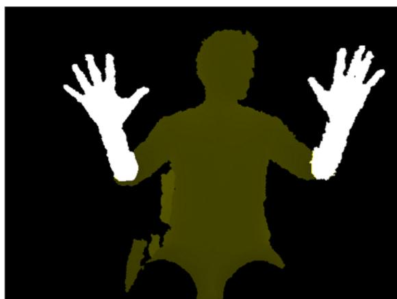
**Figura 23 - Máscara de pixels do usuário (amarelo) sem as partes móveis (branco) que ultrapassaram a barreira virtual.**
