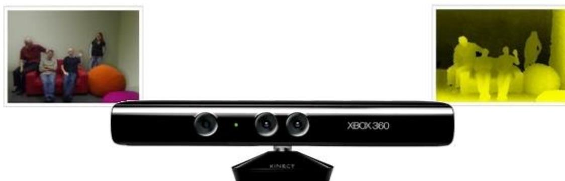
**Figura 2 - Kinect para XBOX 360 e sua segmentação de profundidade**
