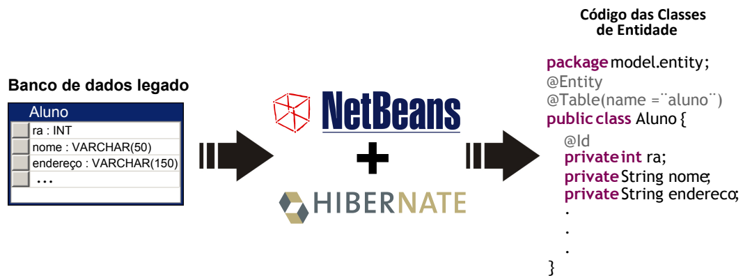
Figura 5.3: Exemplo de geração de código das classes de entidade em Java a partir de um banco de dados.
