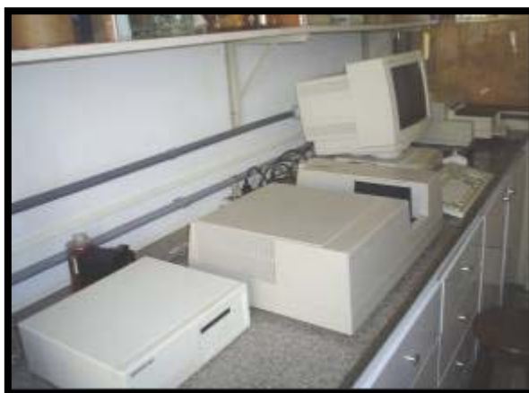
Figura 3.5 – Espectrofotômetro HP UV-Vis G1107A Diode Array, com unidade ótica modelo 8452-A com controlador de temperatura tipo Peltier
