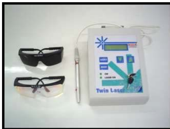
Figura 3.3 - Aparelho de laser infravermelho (GaAlAs) com comprimento de onda de 780nm da Classe IIIB-CEI-IEC 825-1
