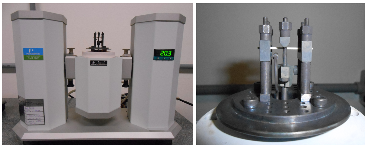
Figura D.1: Na esquerda, vista geral do equipamento DMA8000, pertencente ao LMFEM. Na direita, vista em primeiro plano da configuração de três pontos utilizada na realização das medidas.
