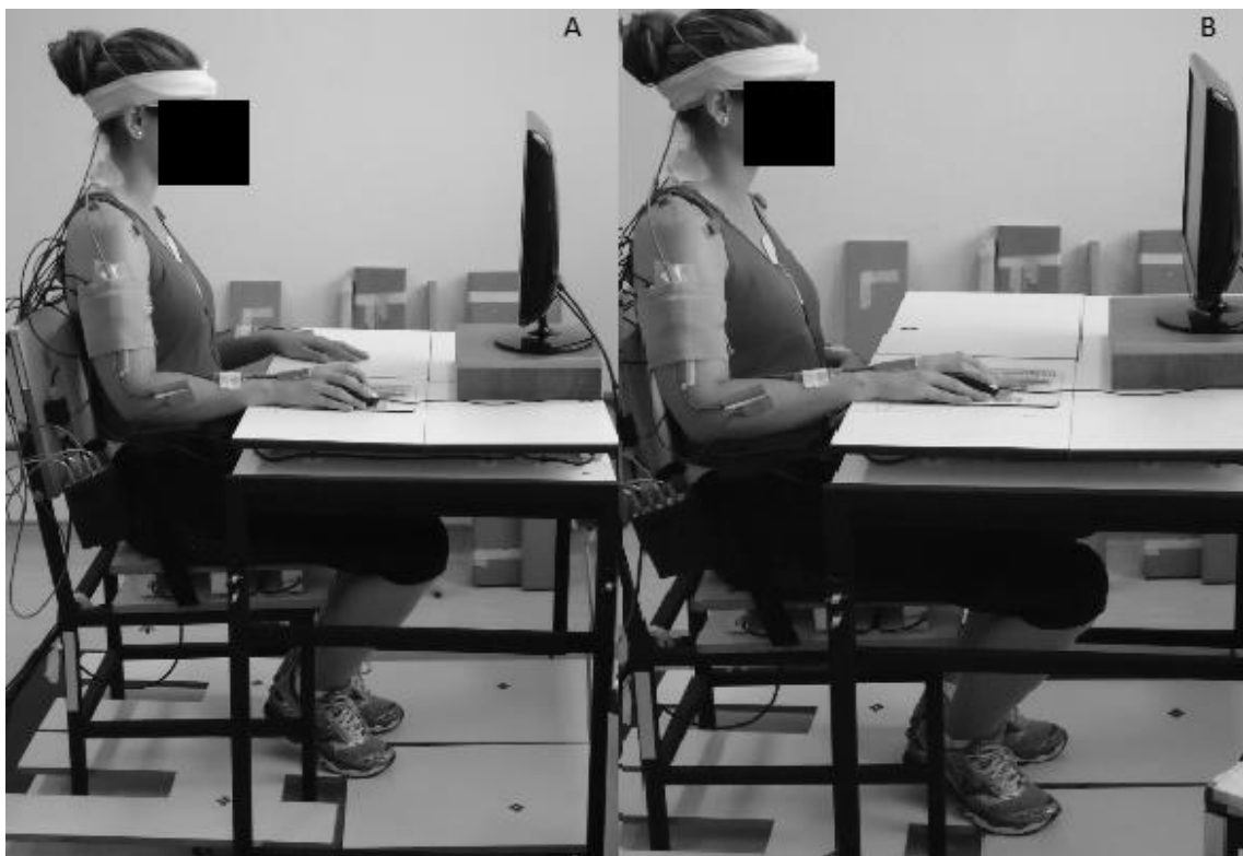
Figura 1. Condições da altura da mesa durante a atividade simulada de mouse . A. altura do cotovelo (AC); B. acima da altura do cotovelo (AAC).
