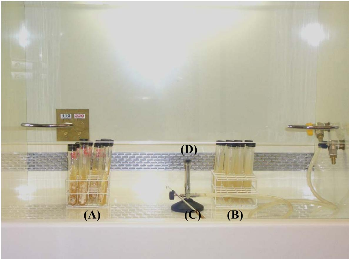
**FIGURA 3.1-** Foto do fluxo laminar com o material necessário para o repique mensal do fungo simbiote *L. gongylophorus*: (A) tubos com meio e o fungo simbiote que foi repicado, (B) tubos com o meio que recebeu o fungo repicado, (C) alça e (D) bico de Bunsen.
