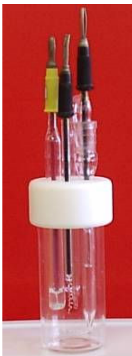
FIGURA 2.2 - Fotografia da célula eletroquímica utilizada nas eletrodeposições e respostas voltamétricas.
