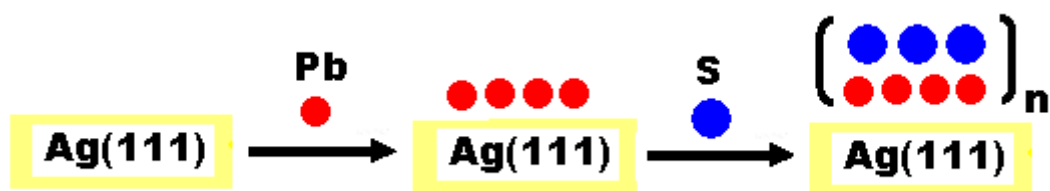
FIGURA 3.46 – Esquema representando a estrutura de ordenação das multicamadas de PbS, onde n = número de ciclos ECALE.
