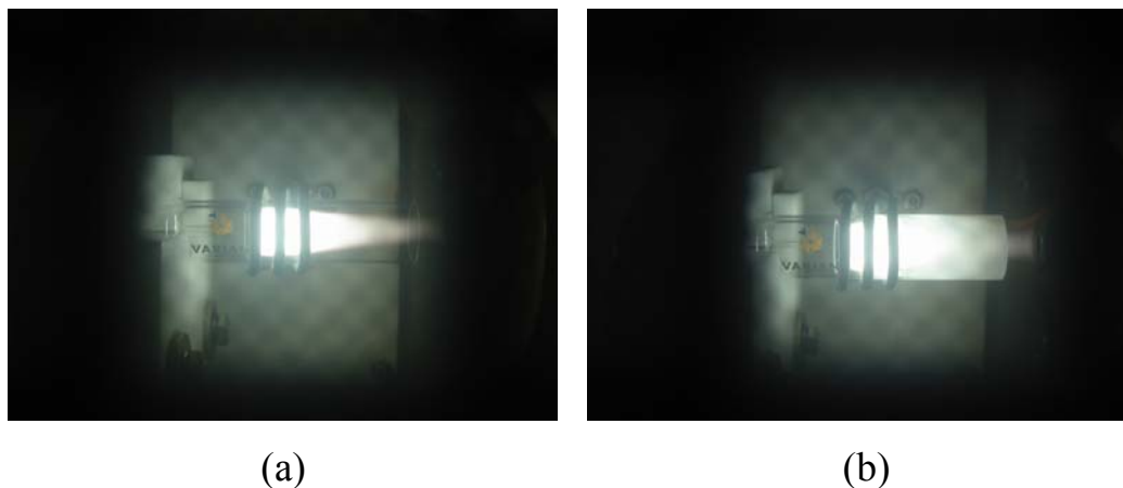
FIGURA 5.4 - (a) Tocha de quartzo axial nova; (b) Tocha de quartzo axial após 4 h de trabalho com introdução de soluções com 2,2 % m/v de sólidos dissolvidos em condição robusta de operação
