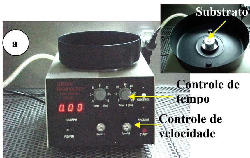
FIGURA 2.4 – Equipamento “Spin-Coating” usado para deposição de filmes finos
