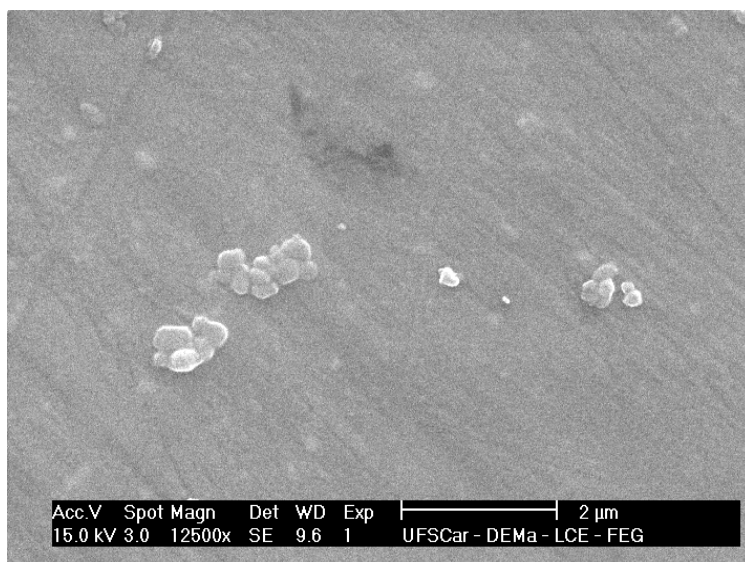
Figura 4.106: Fotomicroscopia de suspensões coloidais de nanocápsulas obtidas por MEV, contendo ricinina. As nanocápsulas foram obtidas pelo método proposto por deposição interfacial/deslocamento do solvente.
