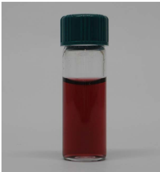
FIGURA 4.1 – Imagem de um frasco contendo uma dispersão coloidal de nanopartículas de ouro.
