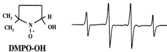
FIGURA 17: Espectro de EPR do aduto DMPO-OH característico da reação do radical hidróxi ( \bullet\text{OH} ) com o “ spin-trap ”, DMPO em solução aquosa.
