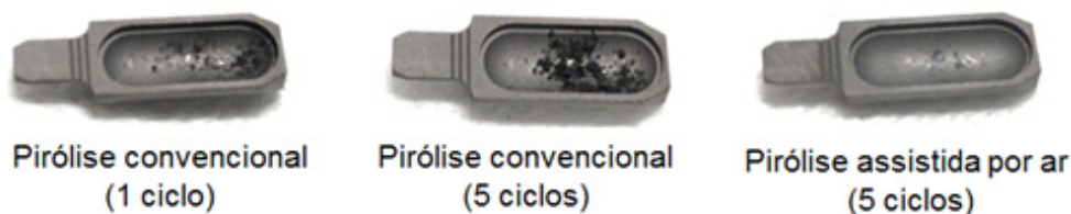
FIGURA 3.4 – Plataformas de grafite para análise de sólidos após ciclos de aquecimento utilizando pirólise convencional e assistida por ar.
