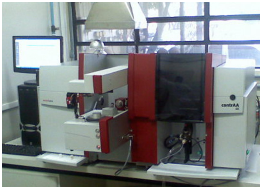
FIGURA 3.2 – Espectrômetro de absorção atômica com fonte contínua e alta resolução em chama ou forno de grafite com análise direta de sólidos Analytik Jena ContraAA 700 (Laboratório do Grupo de Espectroanalítica e Automação – GEA, Instituto de Química, UNESP, Araraquara).
