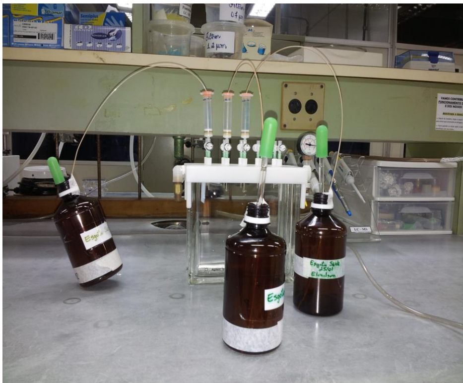
FIGURA 44 – Ilustração do método de SPE para limpeza ( cleanup ) das amostras de efluente.
