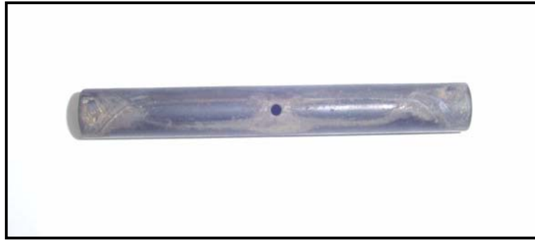
FIGURA 3.5.4 – Foto do tubo atomizador com orifício centralizado onde o jato de líquido é introduzido.
