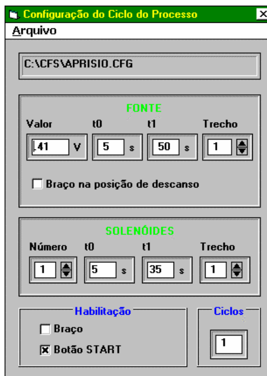
FIGURA 10. Janela do programa de controle da fonte e das válvulas solenóides
