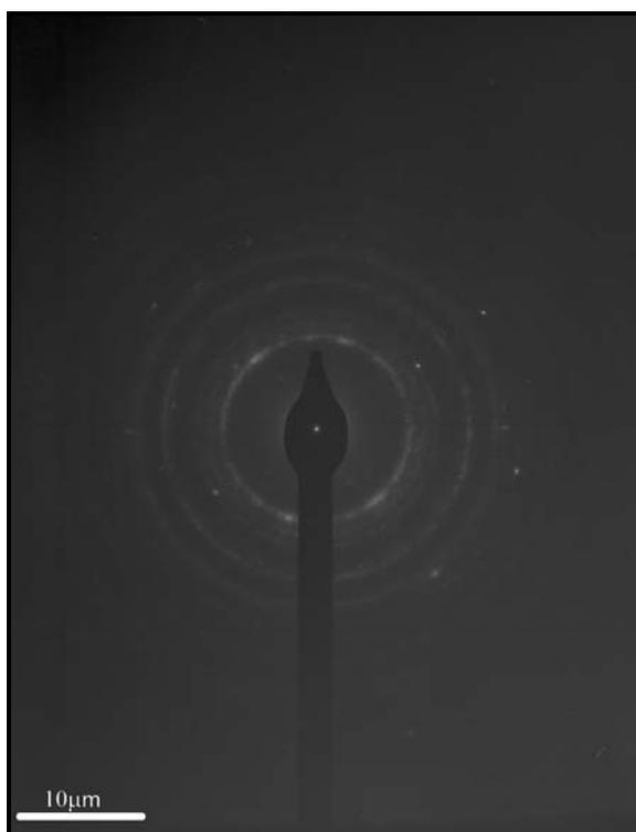
FIGURA 3.80: Difração de elétrons da amostra  $\text{Ce}_{0,84}\text{Co}_{0,16}\text{O}_2$ , calcinada à  $1000^\circ\text{C}$  por duas horas (anéis referentes a fase adicional  $\text{Co}_3\text{O}_4$ ).
