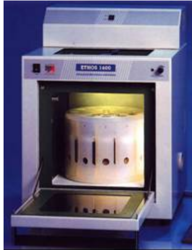
FIGURA 4.6. ETHOS 1600 Milestone equipado com 10 frascos de Teflon PFA. Potência máxima: 1000 W e Pressão máxima: 100 atm (Fonte: www.milestone.it ) 73 .
