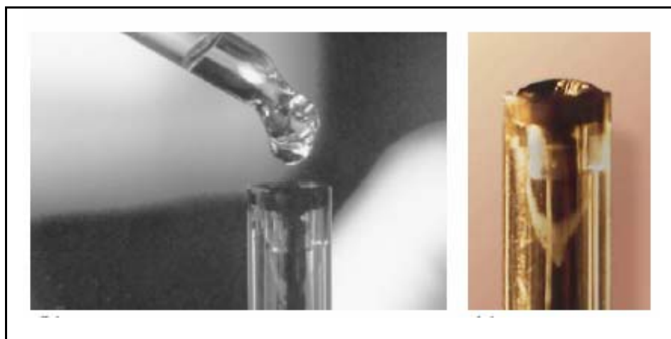
FIGURA 5.2 - Detalhes da etapa de construção do eletrodo. Esquerda: deposição da membrana gota a gota. Direita: gota de coquetel sensor depositada e deixada em repouso para evaporação do solvente.
