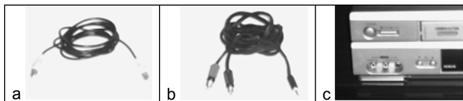
FIGURA 3.8 – Cabos de conexão utilizados para exportar os sinais de áudio e vídeo e a entrada de sinal no videocassete. Cabo para exportar o sinal de vídeo (a), cabo para exportar o sinal de áudio (b) e entradas para conectar os cabos de áudio e vídeo.
