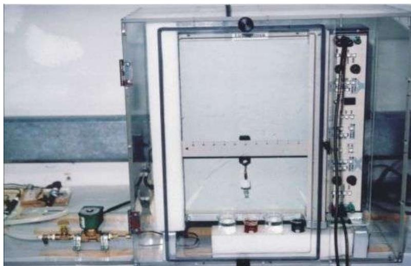
Figura 9: Foto do registrador utilizado como servo mecânico para o desenvolvimento do dispositivo automatizado.
