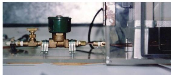
Figura 13: Foto da válvula solenóide usada para acionar o jato de nitrogênio.
