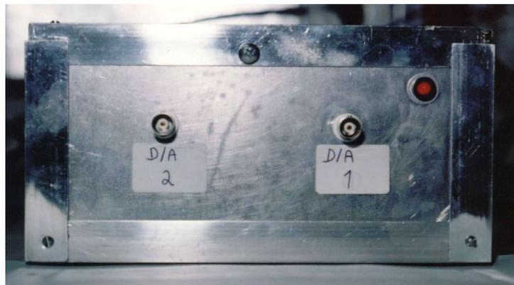
Figura 10: Foto da placa controladora DA. Em destaque as duas saídas DA de 16 bits.
