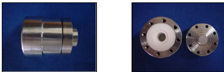
FIGURA 3.6. Pré-coluna utilizada na injeção de amostra em fase sólida.
