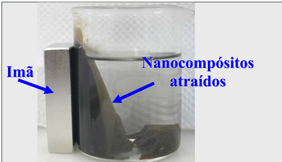
Figura 4. 26. Foto demonstrando o arraste magnético dos nanocompósitos.
