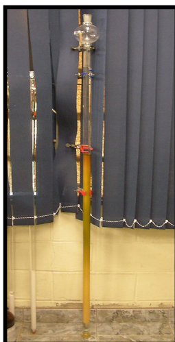
Figura 3.3. Coluna SEPHADEX LH-20 utilizada na pré-purificação do extrato PECL
