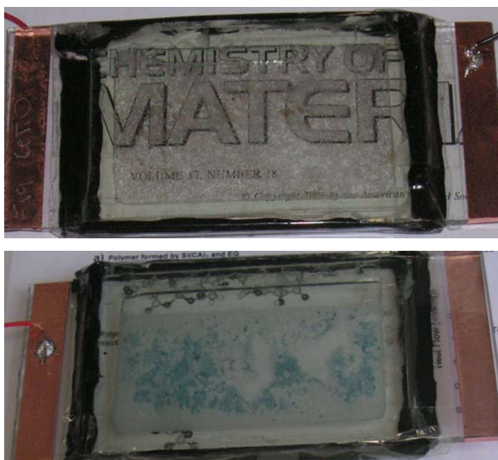
Figura 4.16 Foto dos dispositivos ECI (topo) e ECII (abaixo) após 4000 ciclos (-2,0V, 120s / +1,25V, 120s) em estado completo de degradação.
