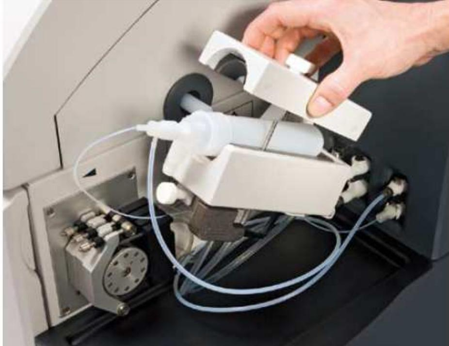
FIGURA 4.1.3.1 – Sistema de introdução de amostras constituído de uma câmara de nebulização de duplo passo (Scott) e um nebulizador concêntrico, ambos de PFA (Varian).
