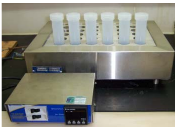
Figura 4.2.3.1 Esquema do bloco digestor e dos frascos utilizados nesse experimento
