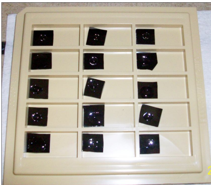
FIGURA 4.1 - Deposição das alíquotas de 20 \mu L dos extratos nas placas de carbetto de silício.
