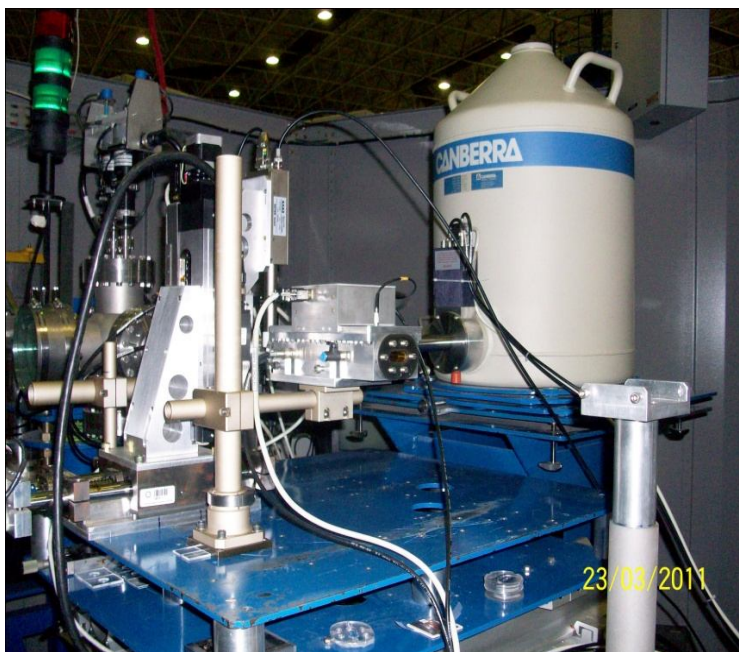
FIGURA 4.2 - Linha de luz XRF do LNLS, onde foram realizadas as medidas de XANES.
