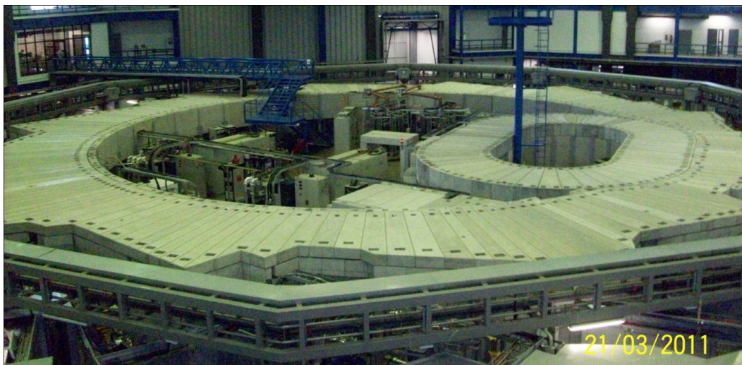
FIGURA 3.1 - Fonte de radiação síncrotron do Laboratório Nacional de Luz Síncrotron, localizado em Campinas (SP).
