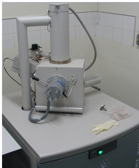
FIGURA 3.3 - MEV da FEI Quanta 250 operando em ESEM.
