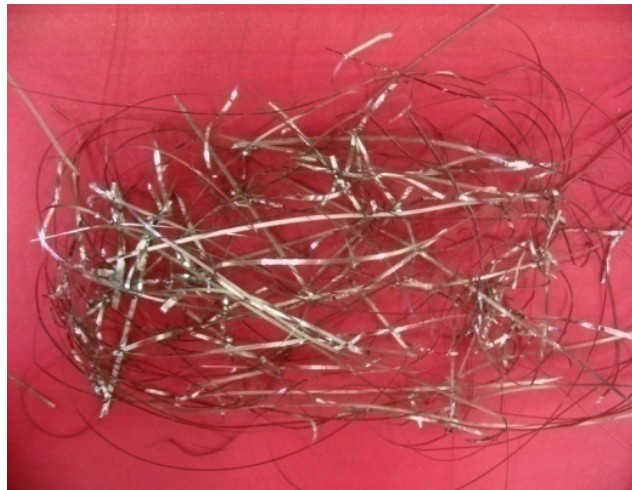
Figura 5.6 Foto da fita da liga \text{Fe}_{66}\text{B}_{30}\text{Nb}_4 obtida com espessura média de 30 \mu\text{m} e largura média de 1,8mm.
