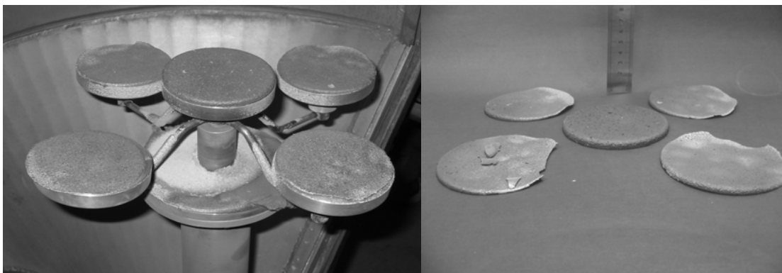
Figura 5.12 Fotos: (a) sistema de substrato com cinco discos com alturas diferentes em relação ao bocal de atomização para estudo dos parâmetros de processo e (b) depósitos formados por deposição em Conformação por Spray.
