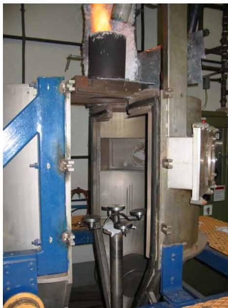
Figura 4.6 Câmara do equipamento de conformação por spray, com “tundish” posicionado na parte de cima da câmara sendo aquecido antes do processamento e substratos posicionados no interior da câmara.
