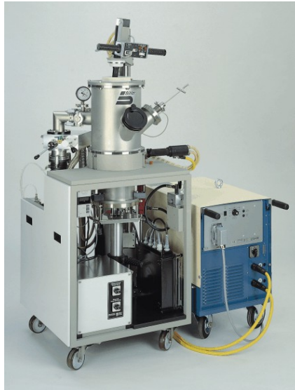
Figura 4.3 Forno a Arco utilizado na preparação das ligas com sistema de alto vácuo e atmosfera controlada.
