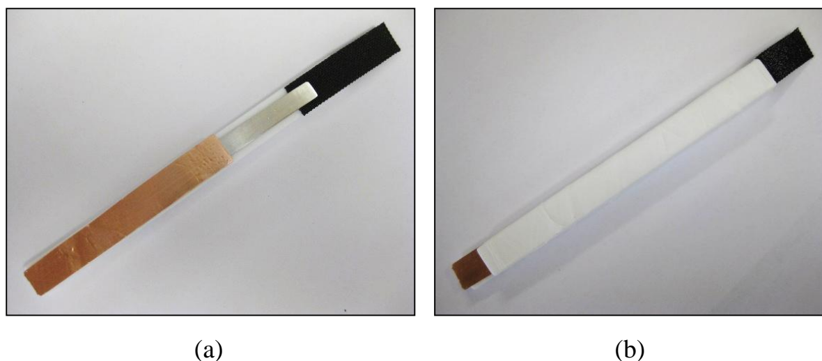
FIGURA 2.2 – Fotografias ilustrando: a) esquema do contato elétrico da fibra de carbono e b) eletrodo com fita de Teflon protegendo o contato elétrico e delimitando a área de trabalho da fibra de carbono.
