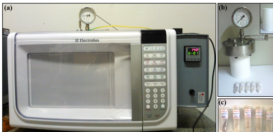
Figura 3.2 – Fotografia do (a) Sistema Hidrotérmico de Micro-ondas em funcionamento; (b) Reator hidrotérmico e copo de Teflon; (c) Amostras obtidas no SHM.
