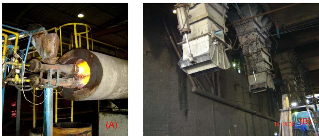
Figura 3.12 Forno rotativo para secagem do concentrado de ferro (A) e saída dos três silos de produtos (B).
