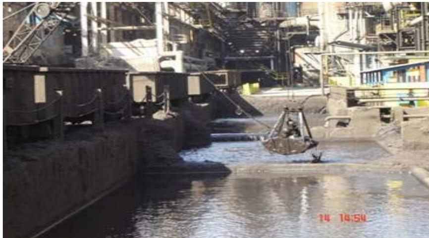
Figura 3.4 Captação da Lama de Alto-Forno sedimentada no fundo da bacia.
