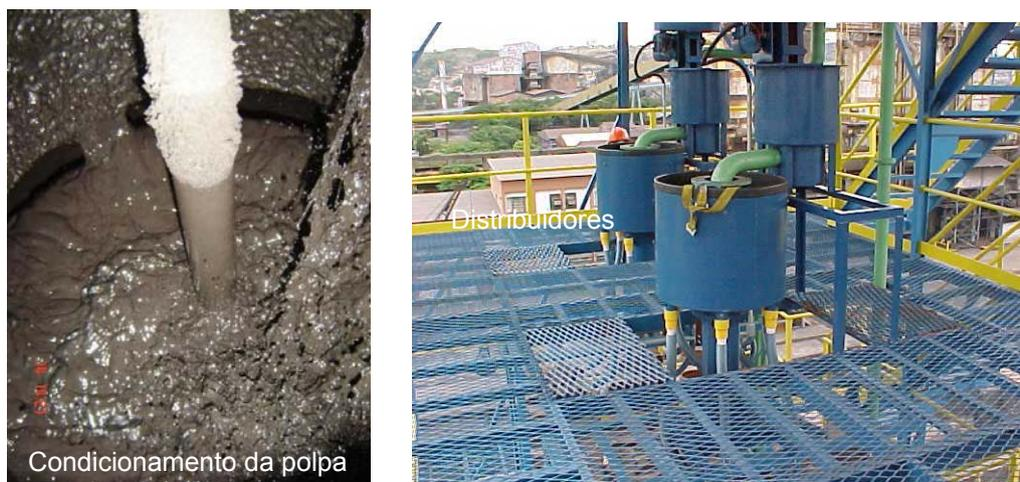
Figura 3.9 Equipamentos de condicionamento e distribuição da polpa para as espirais.
