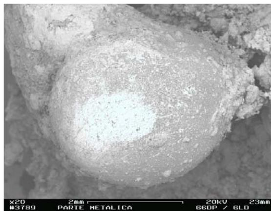
Figura 4.27 Micrografia da pelota com a casca metalizada, contornada por escória e metal fundidos.
