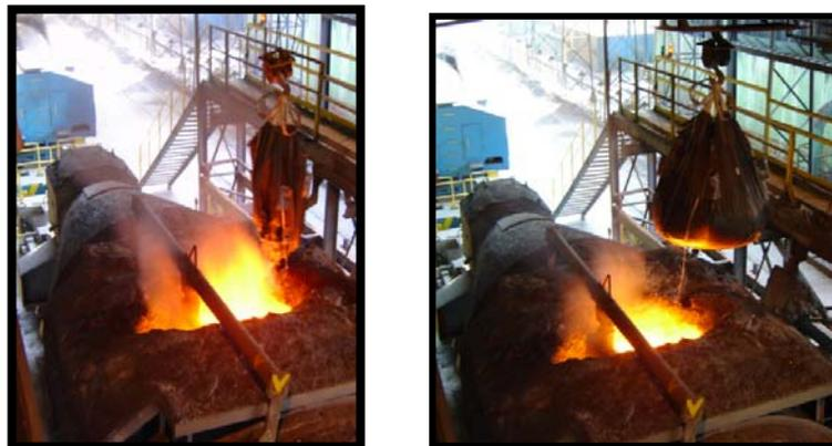
Figura 4.29 Adição das pelotas auto-redutoras na estação dos retentores de escória.
