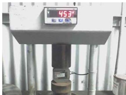
Figura 3.28 Fotografia do equipamento utilizado no ensaio de compressão das pelotas.
