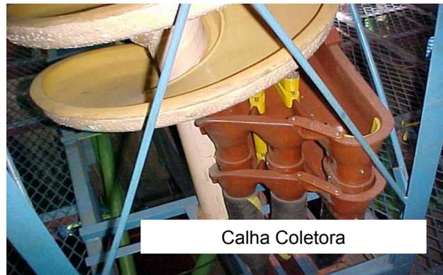
Figura 3.13 Conjunto de espirais e calha coletora dos produtos da concentração gravimétrica.
