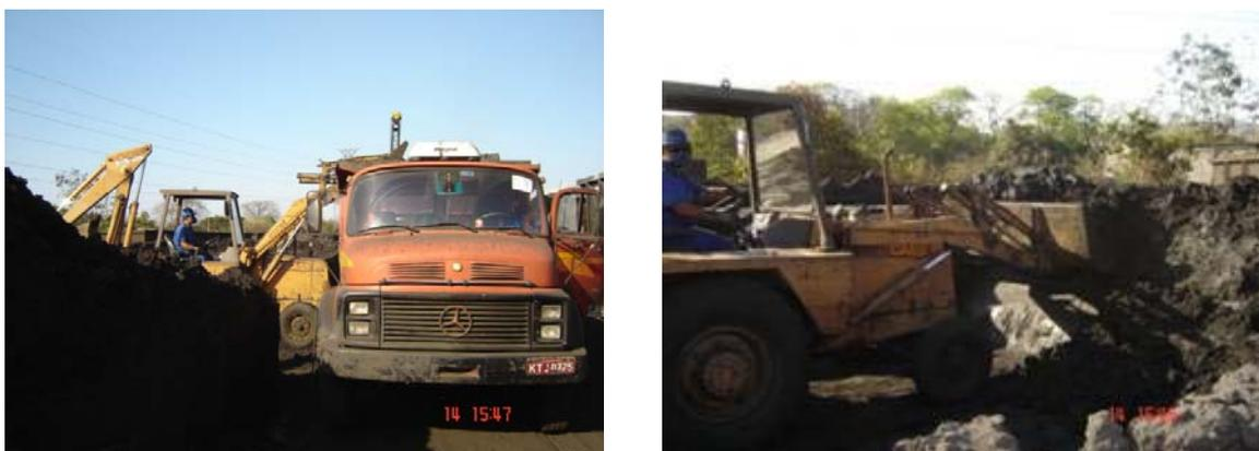
Figura 3.5 Recuperação e transferência da LAF da área de desaguamento para a planta de beneficiamento.
