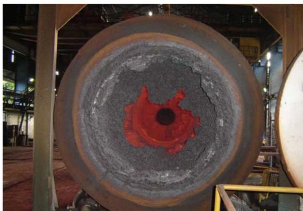
Figura 4.13 Cascão formado na saída do forno rotativo.
