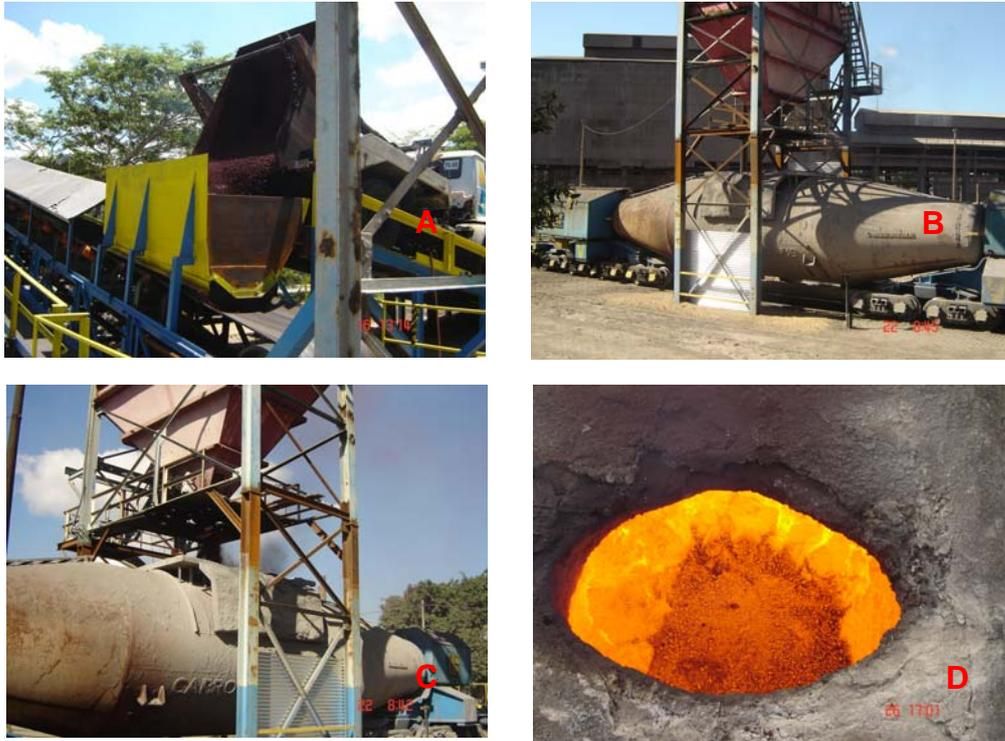
Figura 4.30 Detalhes da estação de adição das pelotas auto-reduzoras nos carros-torpedo => A – Descarga das pelotas, B – Carro torpedo posicionado, C - Adição, D – Pelotas no fundo do carro torpedo.
