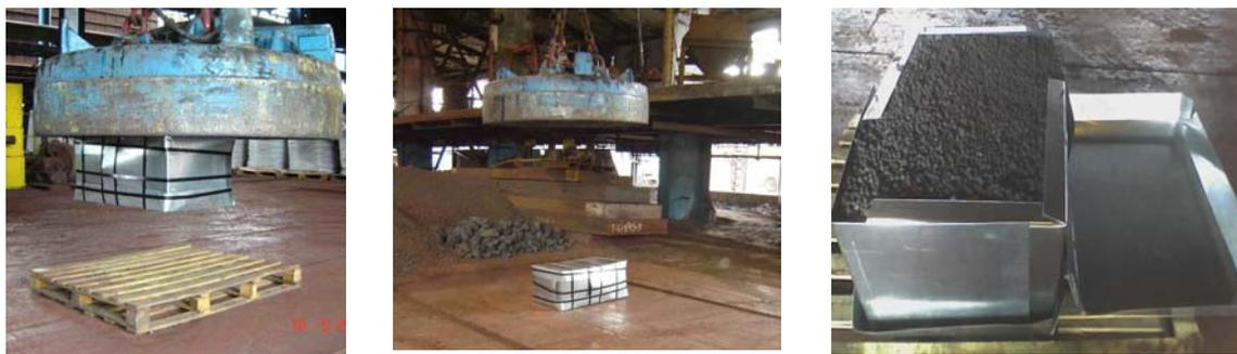
Figura 4.24 Testes de manuseio com eletro-imã da embalagem metálica com as pelotas auto-redutoras.
