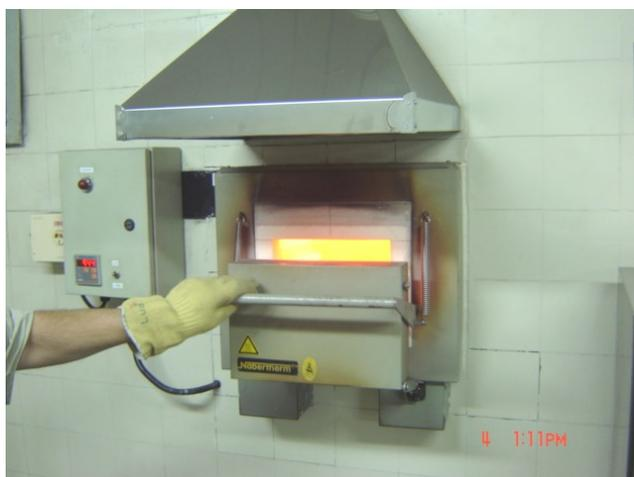
Figura 3.27 Forno mufla utilizado nos ensaios de aquecimento em escala laboratorial.
