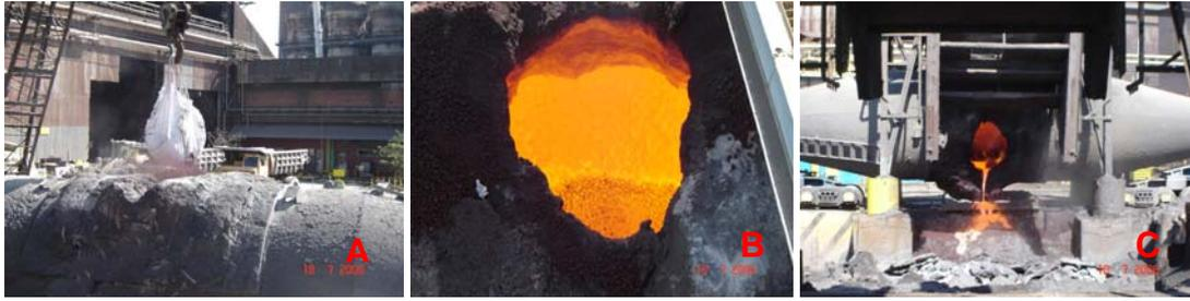
Figura 4.25 Testes iniciais da adição das pelotas auto-redutoras secas no carro-torpedo. A – adição, B – pelotas no interior do CT, C – produção do metal.
