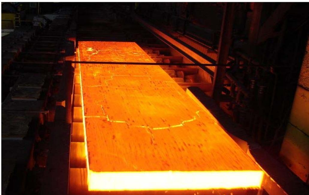
Figura 3.19 Formação da carepa primária na superfície das placas submetidas ao reaquecimento.
