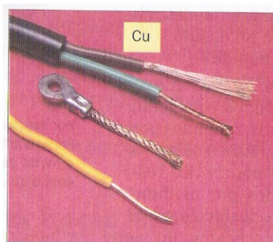
FIGURA 27 – Fio de cobre utilizado na condução de eletricidade.
