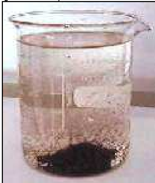
Figura 6 - Decantação dos flocos
