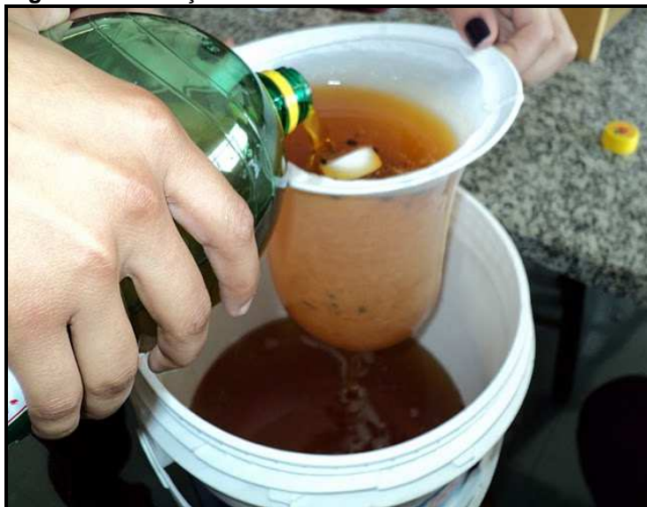
Figura 10 - Filtração do óleo
