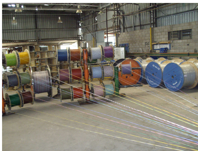
Figura 14 - Confeção de cabo telefônico na Coopersalto
