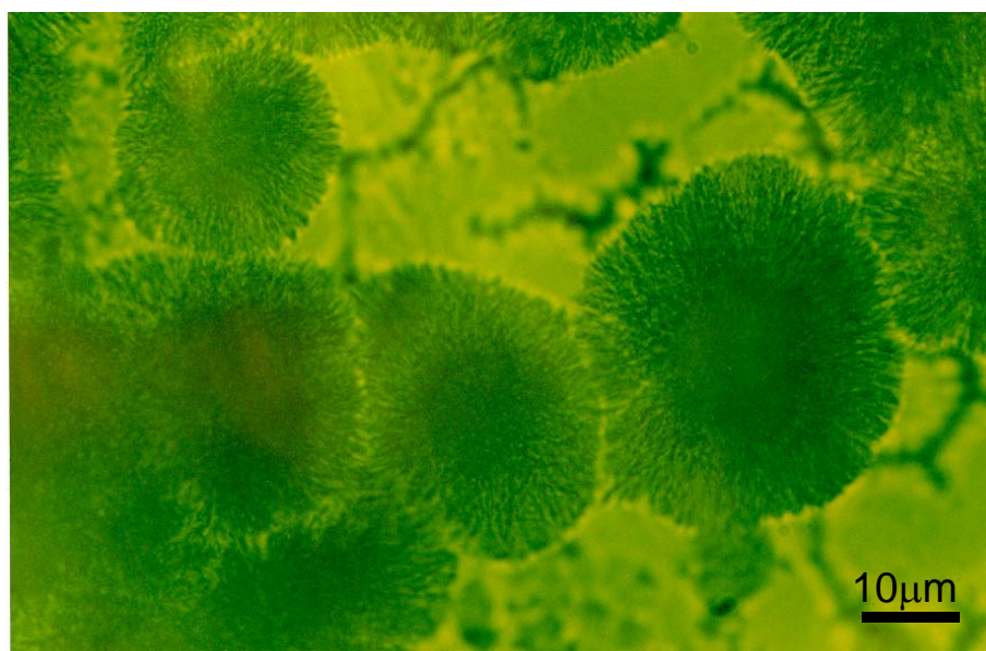
Figura 4.2 Micrografia ótica de transmissão do vidro SSP4 +2% em peso de \text{Cr}_2\text{O}_3 .
