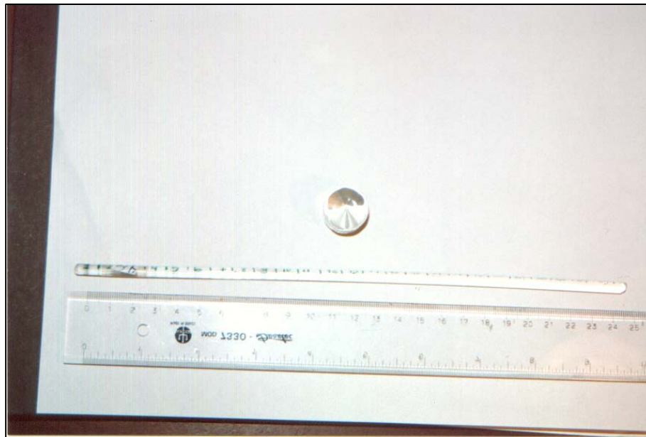
Figura 4.7 Tarugo antes e depois da 4ª extrusão (SSP4+ 2% peso de ZrO_2 )
