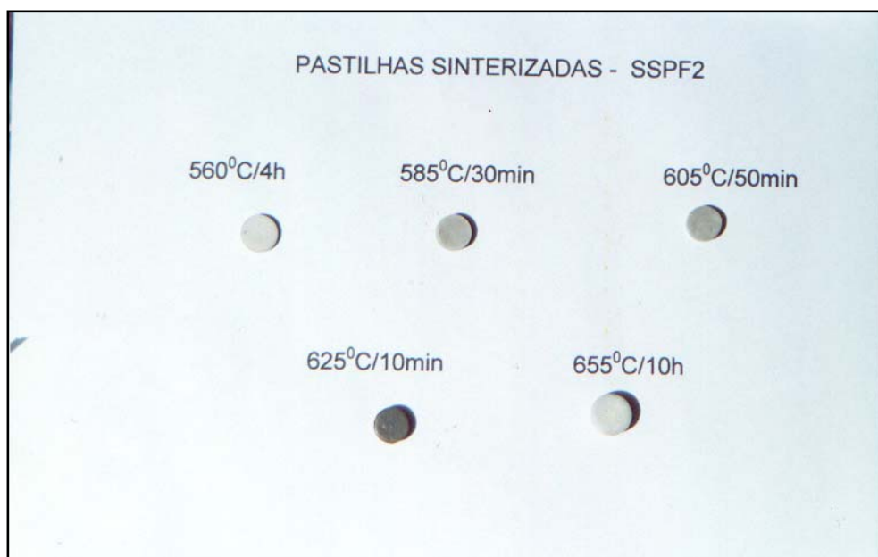
Figura 4.100 Amostras dos vidros SSPF2 sinterizados em diferentes tempos e temperaturas para granulometria ( 38 < n < 75 \mu\text{m} ).
