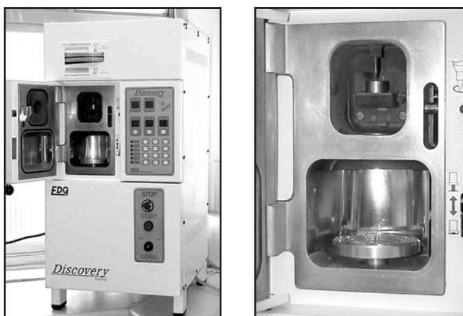
Figura 3.3 – Vista frontal e detalhe da câmara do equipamento de fundição por sucção.
