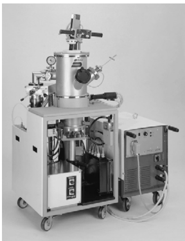
Figura 3.1 – Forno a arco elétrico utilizado para produção dos lingotes.
