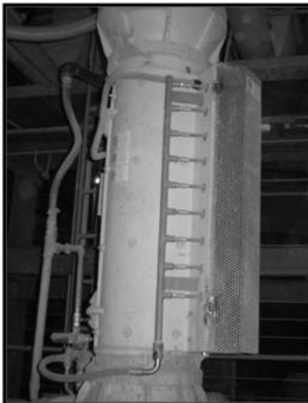
Figura 2.13 Vista externa de um granulador vertical utilizado para granulação de massas através do processo via seca.
