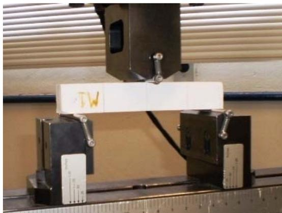
Figura 4.20 Dispositivos empregados para a determinação do módulo de ruptura sob flexão em três pontos.
