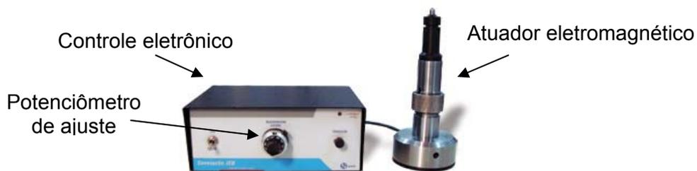
Figura 4.10 Controle eletrônico do atuador eletromagnético, e o próprio atuador.
