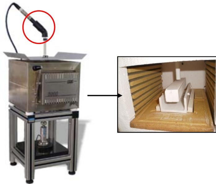
Figura 4.18 Forno instrumentado construído para a caracterização do módulo de Young e do amortecimento durante a secagem com temperatura. O círculo vermelho indica a armadilha para que a irradiação térmica não atinja o captador acústico.
